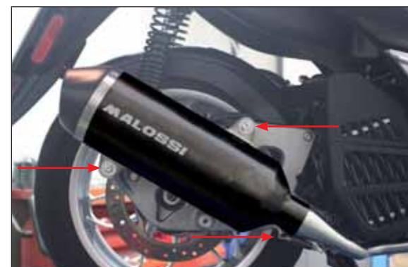
Innestare il terminale, serrare gli attacchi (2) al telaio ed ancorare la molla
