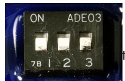
Map 2: Switch n. 3 (siehe Foto). Das ist das Mapping für Polini Motoren mit Ersatzteilkit Polini: Zylinder-Kit Ø 49 mm + Lange Übersetzung + Variator
