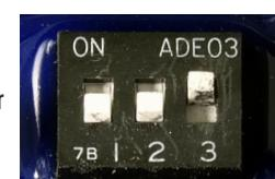
Carte 2: switch n. 3 (voir photo). C'est la carte pour le moteur équipé des pièces Polini avec Kit diamètre 49 mm, rapports allongés et variateur
