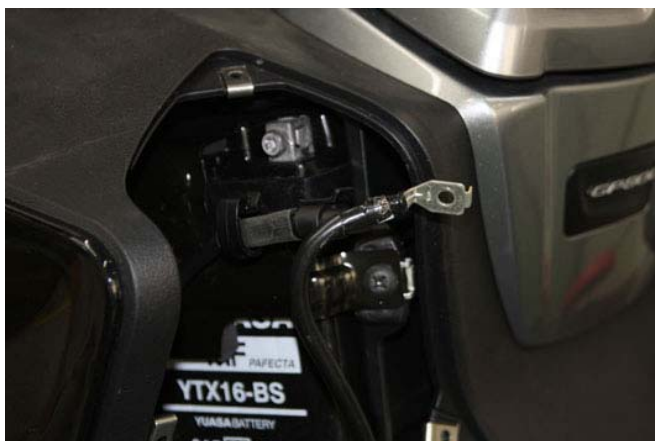
Scollegare i cavi della batteria per evitare danni all'impianto elettrico Unplug battery cables, to avoid any potential damage to electronics and wiring
