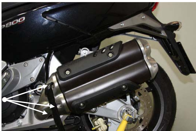
Rimuovere la protezione paracalore, svitando le 3 viti indicate in figura Remove heat cover, unscrewing the screws shown in picture above
