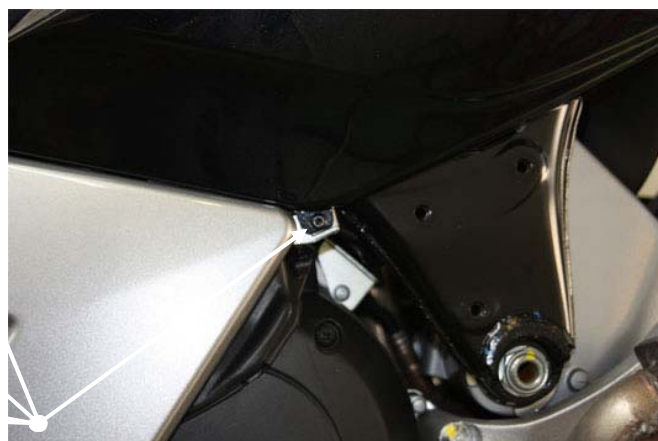
Smontare le carene laterali attraverso le viti indicate (ripetere l'operazione dal lato opposto) Remove side fairings, unscrewing the screws shown in picture above (repeat the same on the other side)
