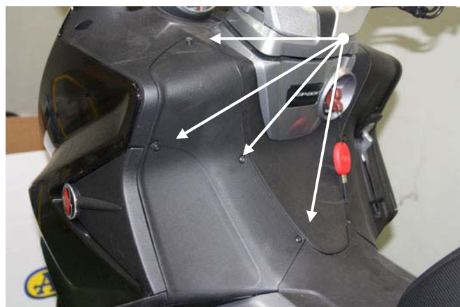
Svitare la placchetta di plastica sotto la quale si trova la batteria Remove the plastic guard covering the battery box
