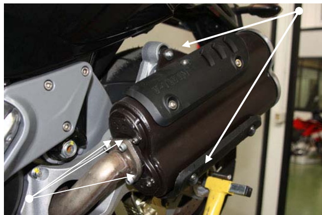
Svitare le viti di sostegno del silenziatore, quindi smontare il silenziatore Remove the screws fixing the silencer, then remove the silencer
