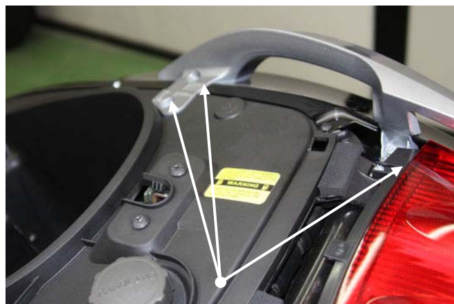
Rimuovere i 2 maniglioni di appoggio Remove passenger's handles
