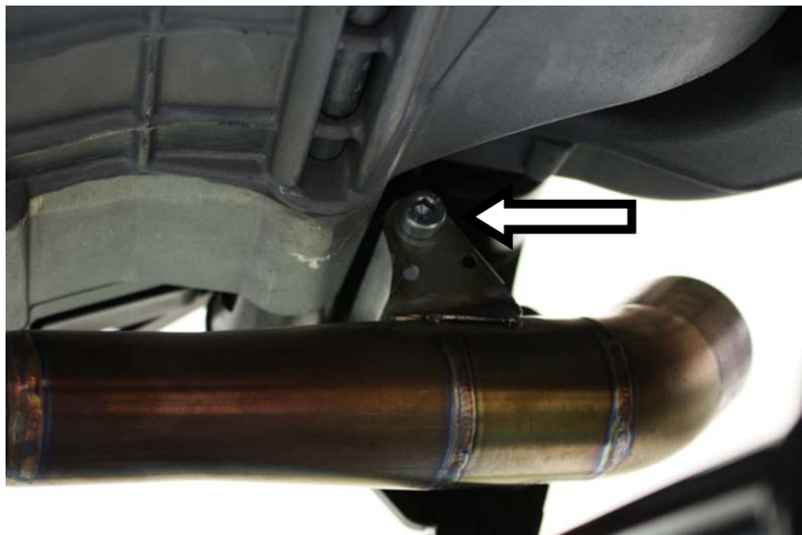
Serrare l'attacco del raccordo allo spessore Secure the 2:1 manifold welded mount to the spacer
