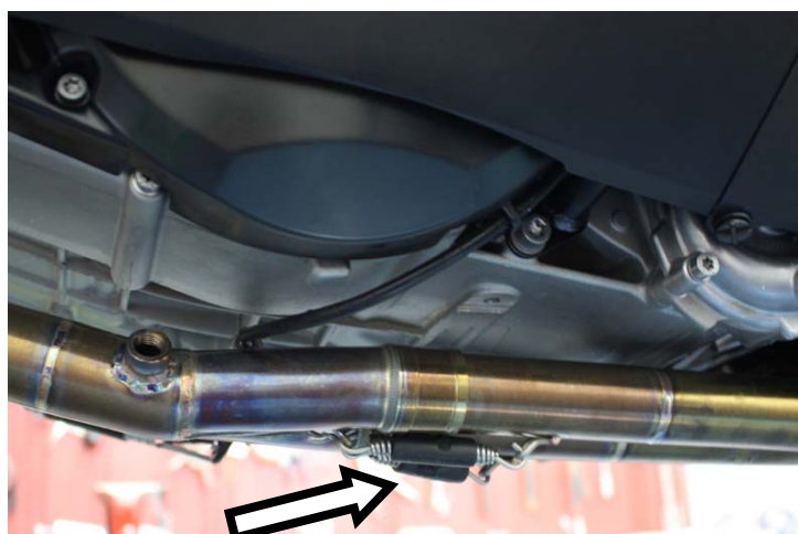
Innestare il raggruppamento ed ancorare le molle Fit 2:1 manifold and secure the springs
