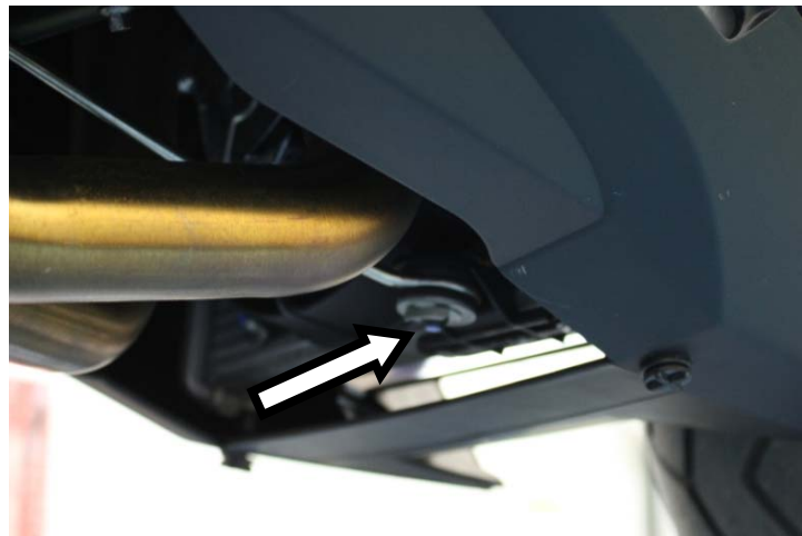
Serrare definitivamente i collettori e rimontare il radiatore Tighten collectors and fit radiator mounting bracket
