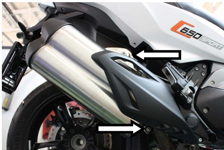
Innestare il terminale, fissarlo alla pedana e serrare la fascetta Fit the silencer to 2:1 manifold, secure it to the footpeg and tighten the hose clip
